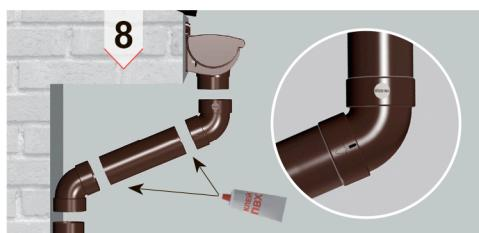
7. Монтаж труб проводиться зверху вниз, починаючи від лійки. Для з'єднання лійки і труби використовується муфта труби. Стрілка на муфті повинна бути спрямована вниз. Отвір у вигляді стрілки дозволяє контролювати введення трубы до позначки «ВСТАВИТЬ ДО». Муфта фіксується кронштейном трубы.
